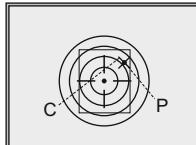
**¡Atención!** La cruz auxiliar (C) puede desplazarse solamente dentro de los marcos del cuadro limitador (ver fig.), el cual determina la banda de ajustes – 80 clics por la horizontal (+40/-40), y 100 por la vertical (+50/-50).
